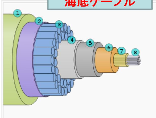
ケーブルの構造 1.ポリエチレン 2. マイラーテープ 3. 鋼鉄線 4.アルミニウム耐水膜 5.ポリカーボネート 6. 銅 又はアルミニウムチューブ 7.ワセリン 8.光ファイバー
